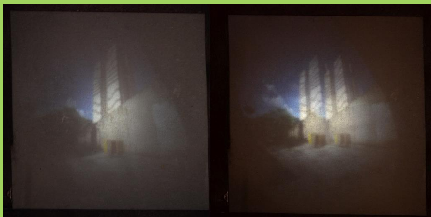
Figura 2: A primeira imagem é a apresentada pela câmera obscura com apenas um orifício e a segunda, possuindo dois furos, compõe a junção de duas “capturas” do cenário, duplicando-o. Arquivo pessoal, 2015.
