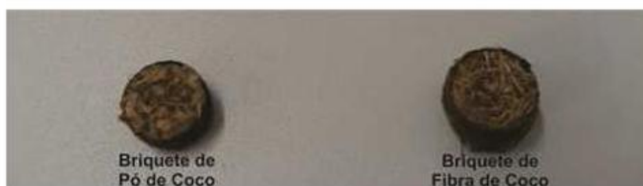
Figura 5. Briquetes do pó e da fibra das cascas do coco verde (ESTEVES, 2014).
